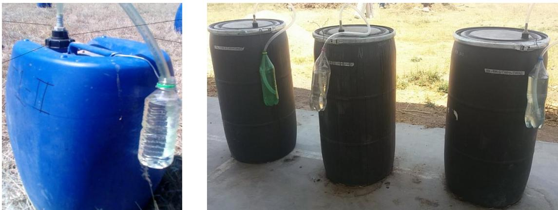
Figura 1. Tipos de biodigestores fabricados artesanalmente con materiales locales.
